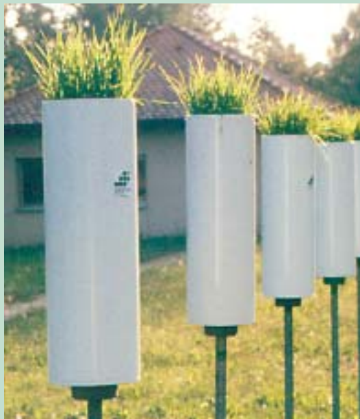
Mittels Graskulturen wird die Belastung durch produktionsspezifische Schwermetalle auf dem Werksgelände untersucht
