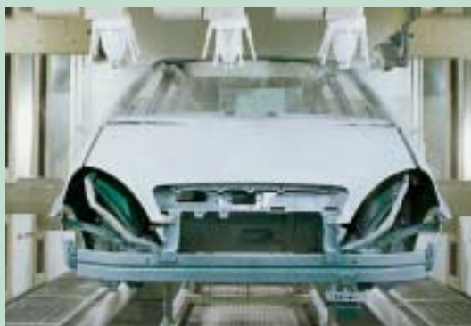
Von der Tauchlackierung über den Auftrag der Wasserbasislacke bis zum Auftrag des Pulver-Slurry-Klarlacks
